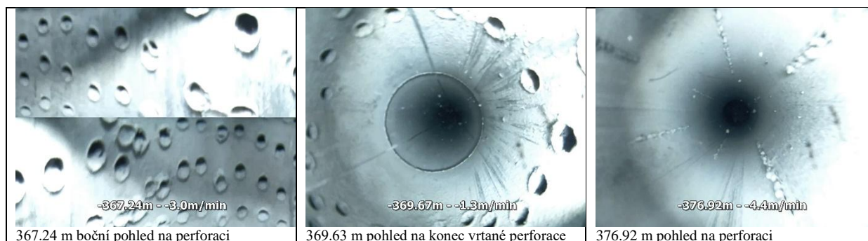
Pažnice antikoro průměr 108 mm, kruhová a prořezávaná perforace
